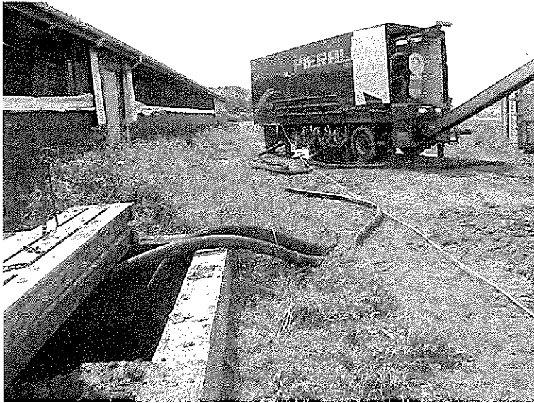
写真4 移動型固液分離装置。左手前のスラリー貯留槽から吸引し、左のタンクとトラックに分離した液分と固形分を排出している。装置は、トラックによって牽引できるトレーラー内に、コントローラー、カッターポンプ、固液分離器、燃料等の稼働に必要な全てが搭載されていた。また、トラブルが生じた際には、自動で携帯電話に知らせるようになっていたことから、1度作動させた後は無人運転が可能とのことである。
