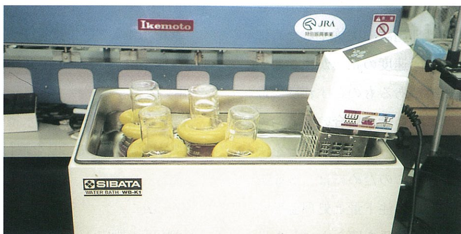
写真2-2 高温区（35℃）の処理状況 （恒温水槽内に、三角フラスコを納めた。）
