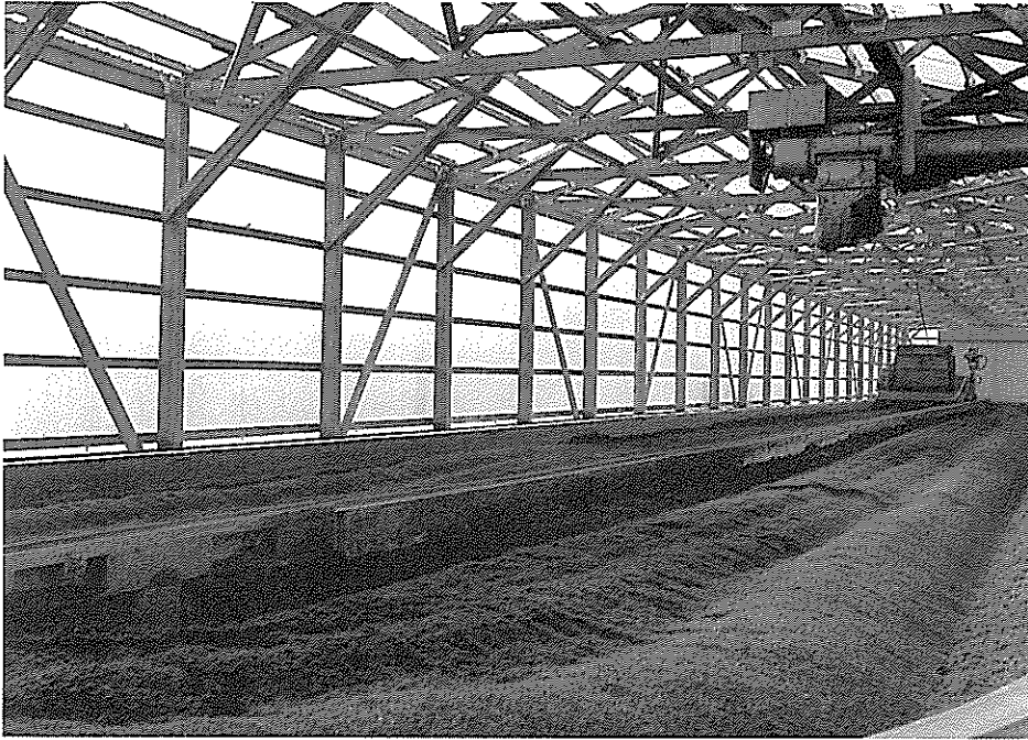
写真2 簡易発酵処理施設を利用したスラリーの堆肥化：もみがらを添加した発酵中の堆肥の上に液状の新鮮ふん尿を散布した後、通風と攪拌を行い、水分の揮散と発酵促進を図っている。しかし、十分な発酵が行われなため、堆肥舎で本格的な発酵を行っている（栃木県I町）。
