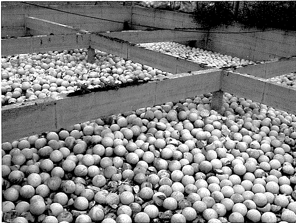
図8 スラリーに発泡スチロールのボールでフタをする試験
