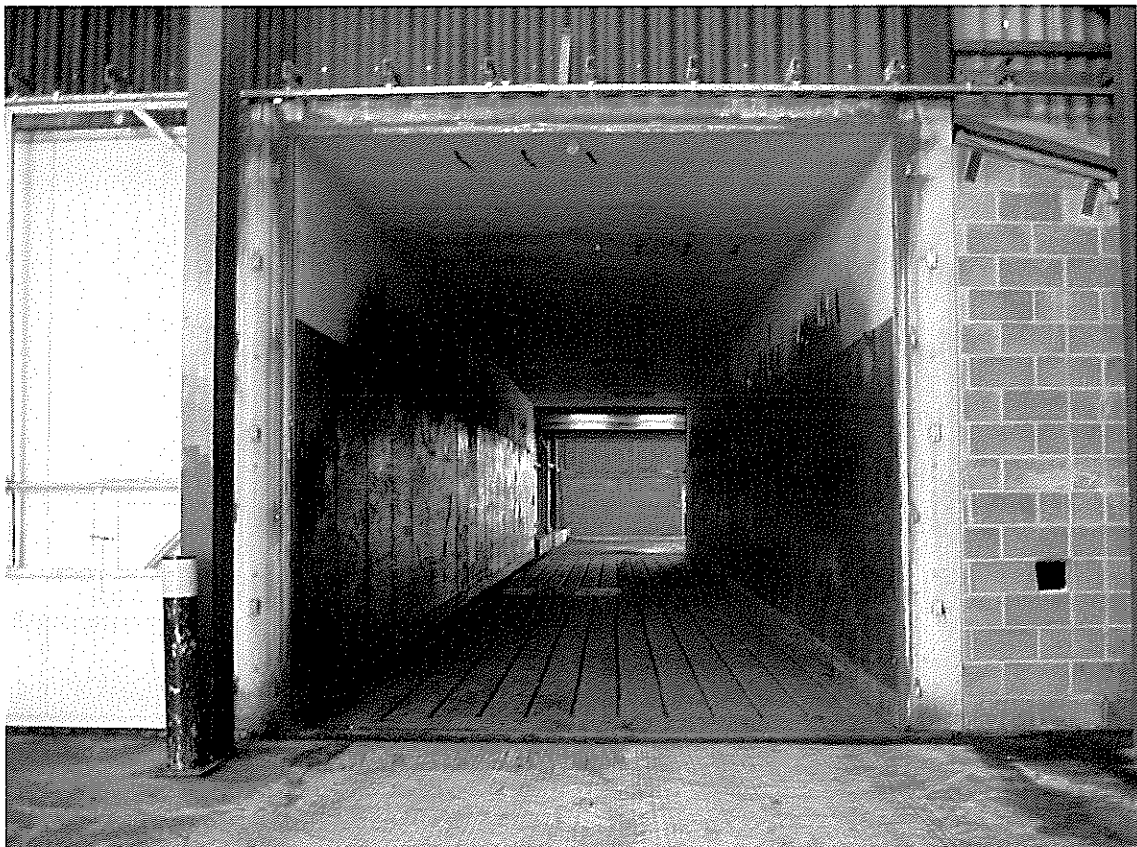
図4 トンネル型発酵槽の扉を開けたところ
