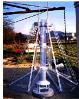
内部攪拌装置写真
