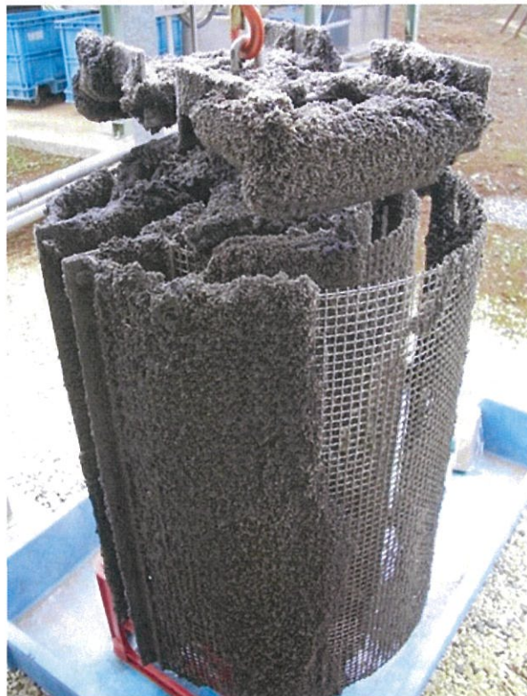
図 4 付着回収用部材表面に付着した MAP (付着 MAP を一部剥落させてある)
