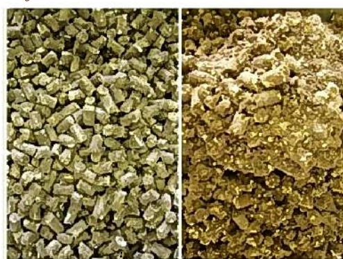
写真 1 正常な完成肥料（左）と膨化・固結した完成肥料（右）
