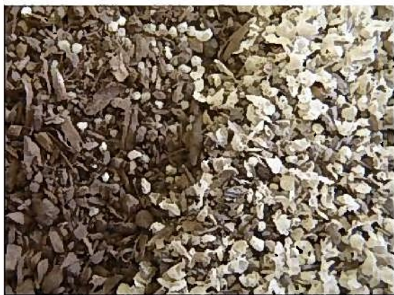
写真2 被覆肥料を含む原料(左側)を造粒機のローラーで加圧したもの(右側)
