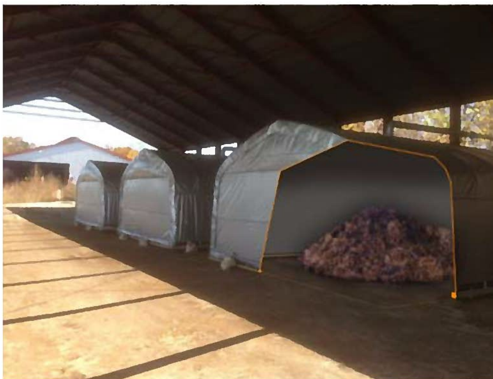
写真1 乳牛ふんの堆肥化過程からの温室効果ガス抑制実証試験(北海道S町:各区10m 3 規模の乳牛ふん混合物を堆積/切り返して約6ヶ月間評価検証)
