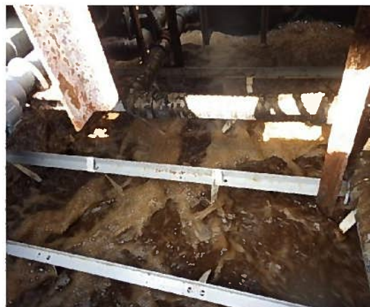
写真 3 炭素繊維担体リアクターによる養豚排水浄化実証試験 (岡山県 N 市：畜舎汚水処理施設、100m 3 浄化槽への適応試験)
