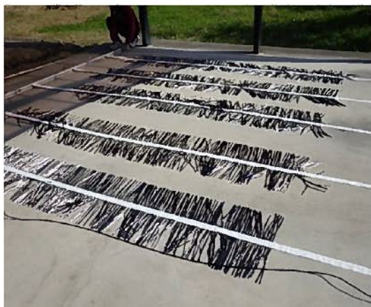
写真 3 炭素繊維担体リアクターによる養豚排水浄化実証試験 (岡山県 N 市：畜舎汚水処理施設、100m 3 浄化槽への適応試験)
