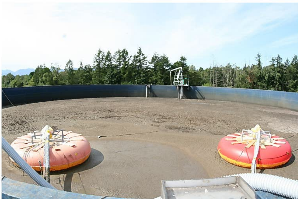
写真2 貯留スラリーからの温室効果ガス発生測定システム（北海道 S 町：測定精度の検証のために、実際の酪農家のスラリートンクに複数の測定用チャンバーを設置／測定している）
