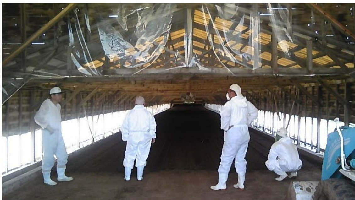
写真6 鶏ふん乾燥施設のアンモニアと温室効果ガス測定(石川県H市:1512m 3 幅7.5m×長さ73.3m×高さ3.5m)
