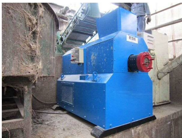
写真4 補助事業を活用し整備した 堆肥成型機
