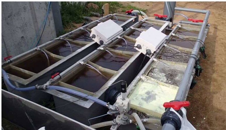
参考写真2 粉末硫黄を利用する脱窒装置の一例
