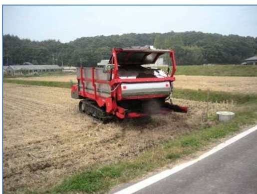
写真2 マニユアスプレッダーでの堆肥散布
