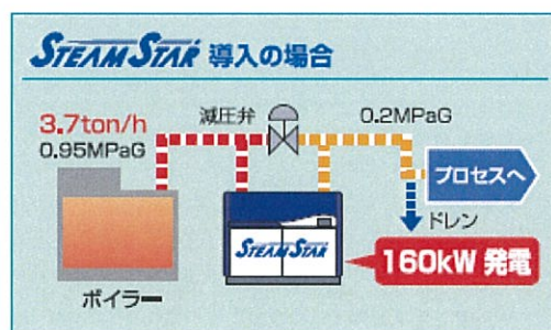
図2 スクリューコンプレッサー方式での蒸気発電システム（神戸製鋼（株）の資料より抜粋）
