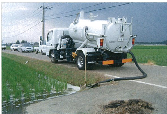
写真1 メタン発酵消化液の水稲への流し込み追肥（約4 tを20分以内で注入する）
