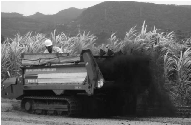
堆肥を散布する様子
