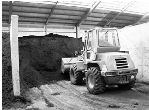
養生槽での切り返し作業
