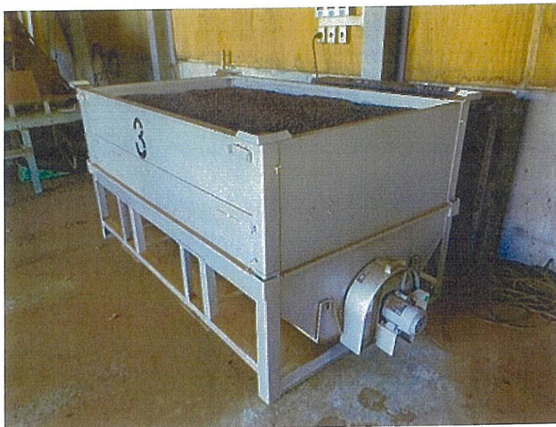
写真 15 造粒堆肥を冷却および水分率を下げる排風機付穀物コンテナ
