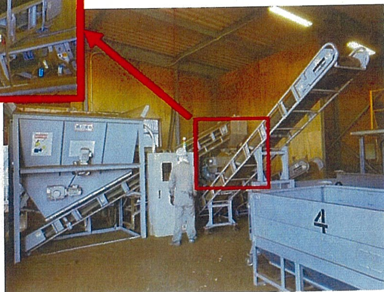
写真 12 造粒システム一式と造粒装置の拡大写真
