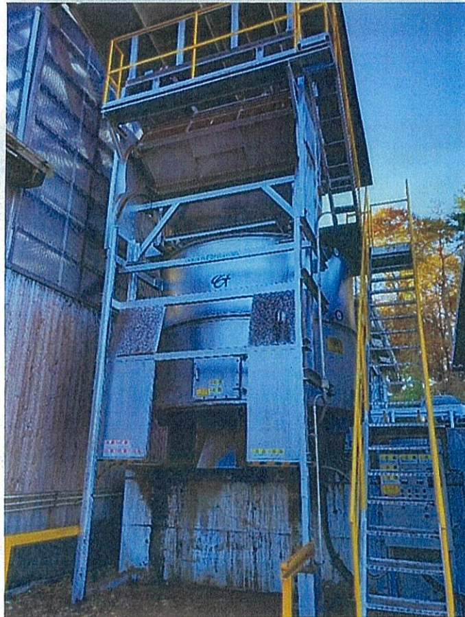
写真 10 密閉縦型発酵装置
