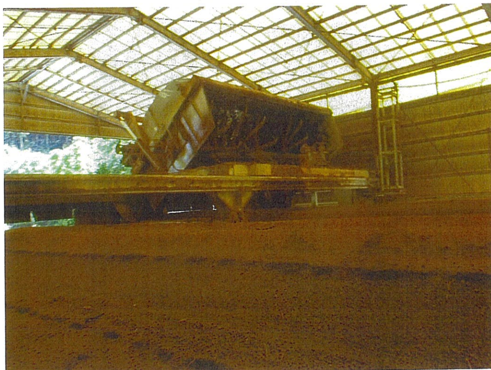
写真6 開放・直線型堆肥化装置(ロータリ式攪拌装置)
