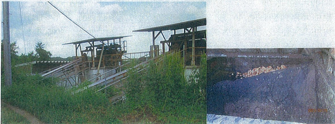
写真2 2基の縦型コンポスター(左)と投入豚ふんの状態
