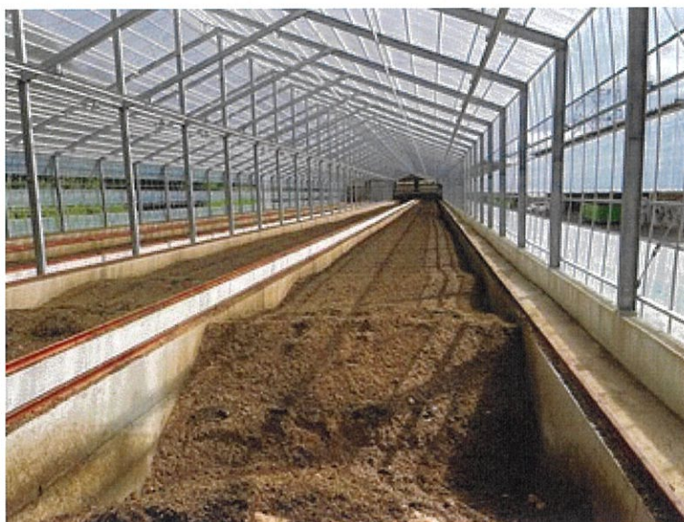
写真7 開放・直線型堆肥化装置(下部通気付)
