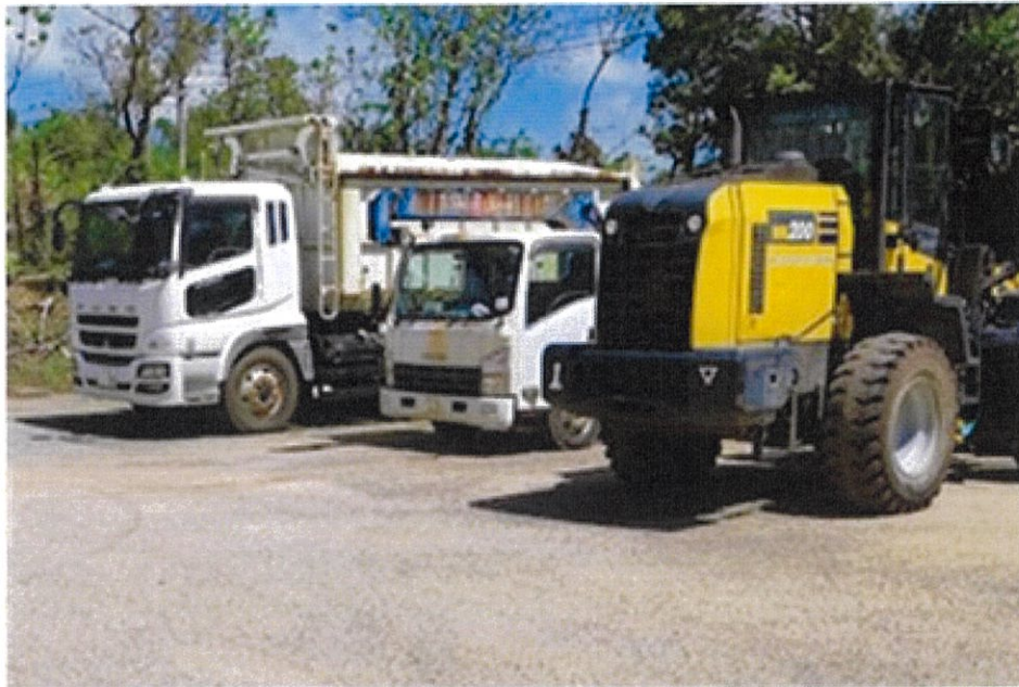
写真2 左から原料運搬車(4トンダンプ)、堆肥運搬車(4トンクレーン)、ショベルローダ
