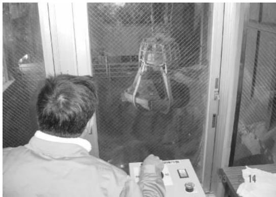
大型クレーンによる鶏ふん燃料の投入作業
